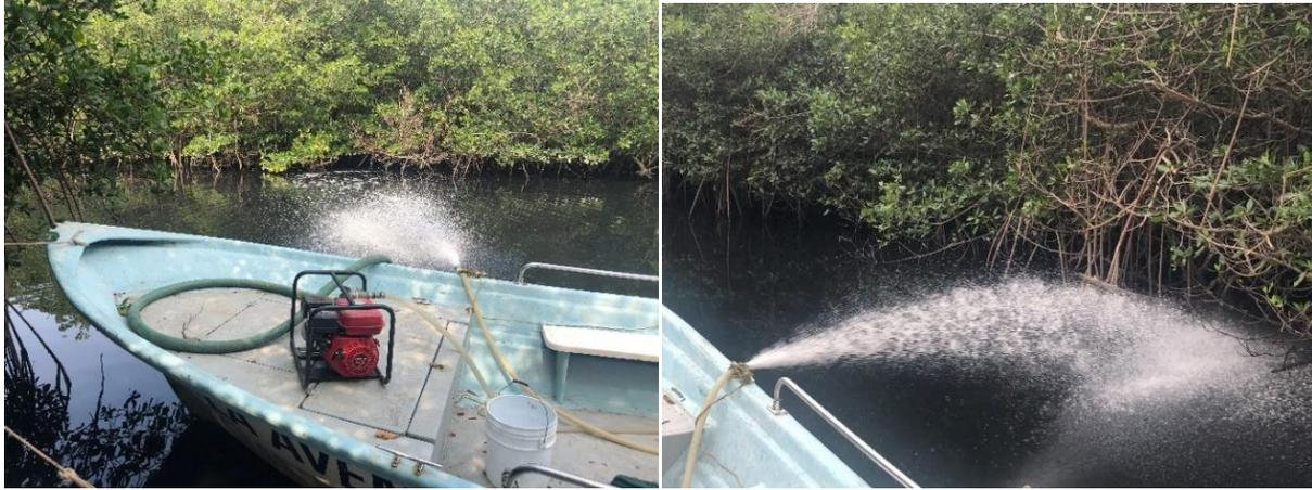
*Ilustración 16. Aireación con motobomba*
